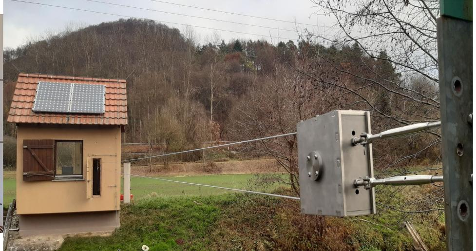
An Brücke: Messpfeiler auf Betonfundament, mit abnehmbarer Kurbel, Befestigung Rollenblock am Widerlager
